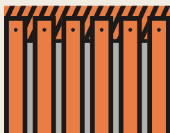
Tábuas pregadas NA ESTRUTURA PRINCIPAL → FIG. 28
