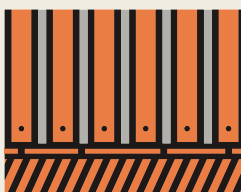
Tábuas pregadas NO PISO TABUADO → FIG. 29
